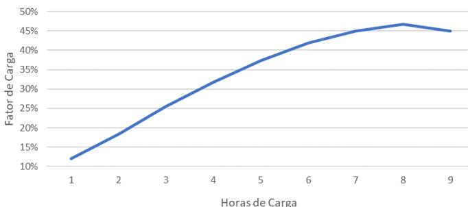
Figura 31. Relação do Fator de Carga pela variação da quantidade de horas disponíveis para recarga.
