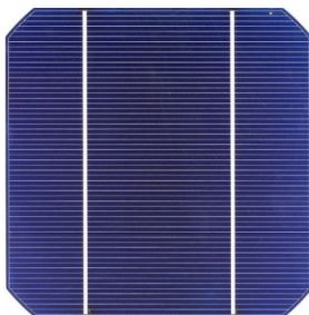
Figura 2.11 - Face frontal de uma célula FV de silício monocristalino.
