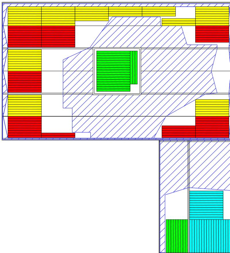
**Figura 22 – Alocação dos módulos PVL-144 da UNI-SOLAR, sem utilizar as áreas consideradas sombreadas.**
