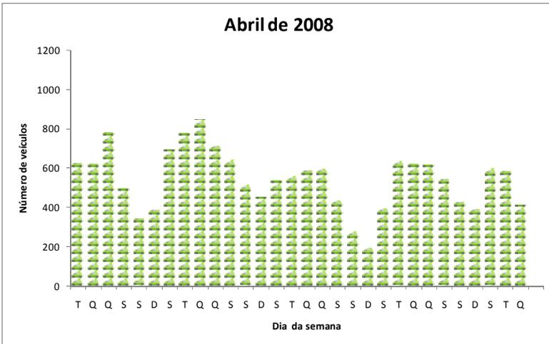
Figura 4.6. Número máximo de veículos elétricos utilizados como geradores distribuídos diariamente no alimentador TDE 05 no mês de Abril de 2008 no horário das 19h às 24h.
