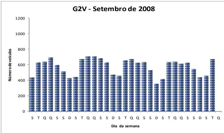
Figura 4.24. Número de veículos elétricos possíveis de serem recarregados diariamente no alimentador TDE05 no período da manhã em função do número de veículos elétricos utilizados na noite anterior como suporte à rede elétrica no mês de Setembro de 2008 no horário da 0h às 06h.
