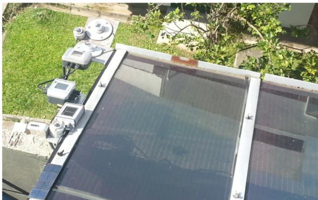
**Figura 32. Piranômetros e células de referência do sistema FV de 2kWp.**
