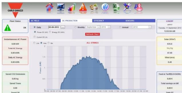
**Figura 23. Supervisório de sistemas FV em plataforma WEB (GAVAZZI, 2012)**
