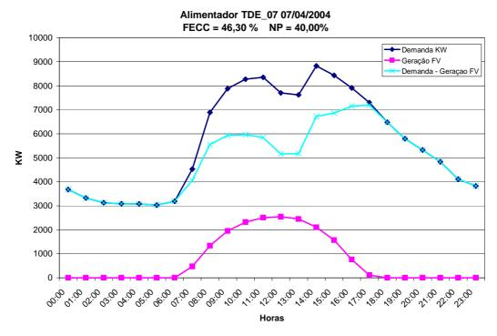
**Gráfico 5.13**: Curvas de Demanda, Geração fotovoltaica para um NP de 40% e Demanda menos Geração fotovoltaica para o alimentador TDE-07 no dia 07/04/2004.
