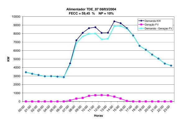
**Gráfico 5.8**: Curvas de Demanda, Geração fotovoltaica para um NP de 10% e Demanda menos Geração fotovoltaica para o alimentador TDE-07 no dia 08/03/2004.
