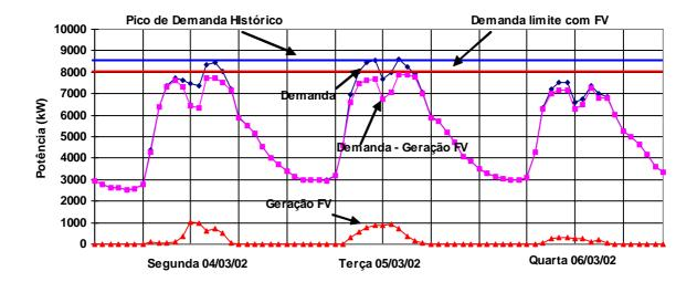
**Gráfico 5.5 -** Comportamento da demanda do alimentador TDE\_07 para três dias consecutivos com perfis distintos de irradiação solar. A curva superior (losangos) é o perfil original da curva de carga; a curva mais baixa (triângulos) representa a geração FV correspondente aos três dias e a curva intermediária (quadrados) mostra a perfil resultante da carga que o alimentador tem que atender. Mesmo em um dia bastante nublado, o nível "Demanda limite com FV" não foi excedido.
