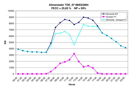
**Gráfico 5.15**: Curvas de Demanda, Geração fotovoltaica para um NP de 50% e Demanda menos Geração fotovoltaica para o alimentador TDE-07 no dia 09/03/2004.
