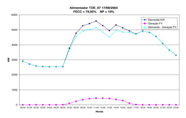
**Gráfico 5.7**: Curvas de Demanda, Geração fotovoltaica para um NP de 10% e Demanda menos Geração fotovoltaica para o alimentador TDE-07 no dia 17/09/2004.
