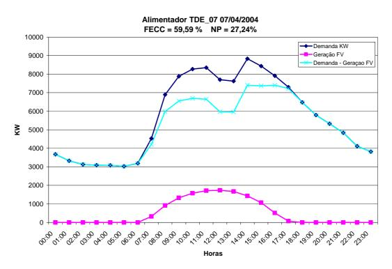
**Gráfico 5.12**: Curvas de Demanda, Geração fotovoltaica para um NP de 27,24% e Demanda menos Geração fotovoltaica para o alimentador TDE-07 no dia 07/04/2004.
