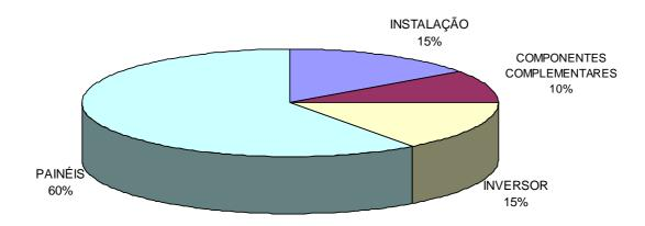
**Gráfico 3.1**: Distribuição típica dos custos no *1000 Roofs Program* para sistemas residenciais interligados à rede e com potência de 2kWp (Sick & Erge, 1996).
