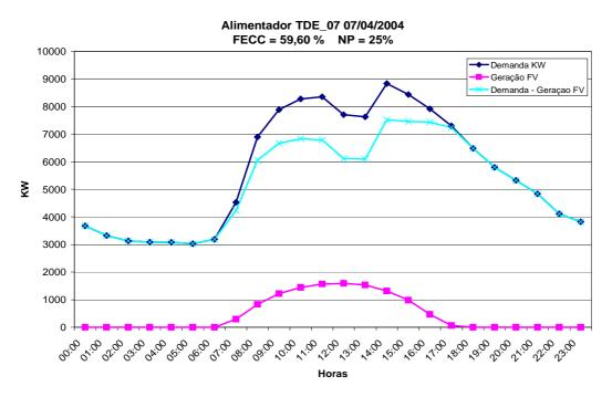
**Gráfico 5.11**: Curvas de Demanda, Geração fotovoltaica para um NP de 25% e Demanda menos Geração fotovoltaica para o alimentador TDE-07 no dia 07/04/2004.
