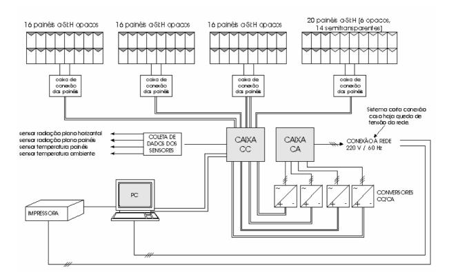
**Figura 4.4**: Diagrama esquemático do SFIRD 2kWp conectado ao alimentador TDE-07 e integrado ao prédio do Departamento de Engenharia Mecânica da UFSC (Rüther, 1998).
