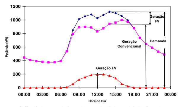
**Gráfico 4.2** -A curva superior (losangos) é a curva do perfil de carga original do alimentador; a curva inferior (triângulos) representa a geração fotovoltaica para o dia correspondente, com determinado nível de penetração; a curva intermediária (quadrados) mostra a nova curva de demanda, com o novo pico, que o alimentador tem que suprir (Jardim *et al*, 2008).
